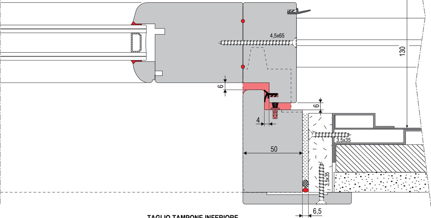
TAGLIO TAMPONE INFERIORE PER CONTROTELAIO
