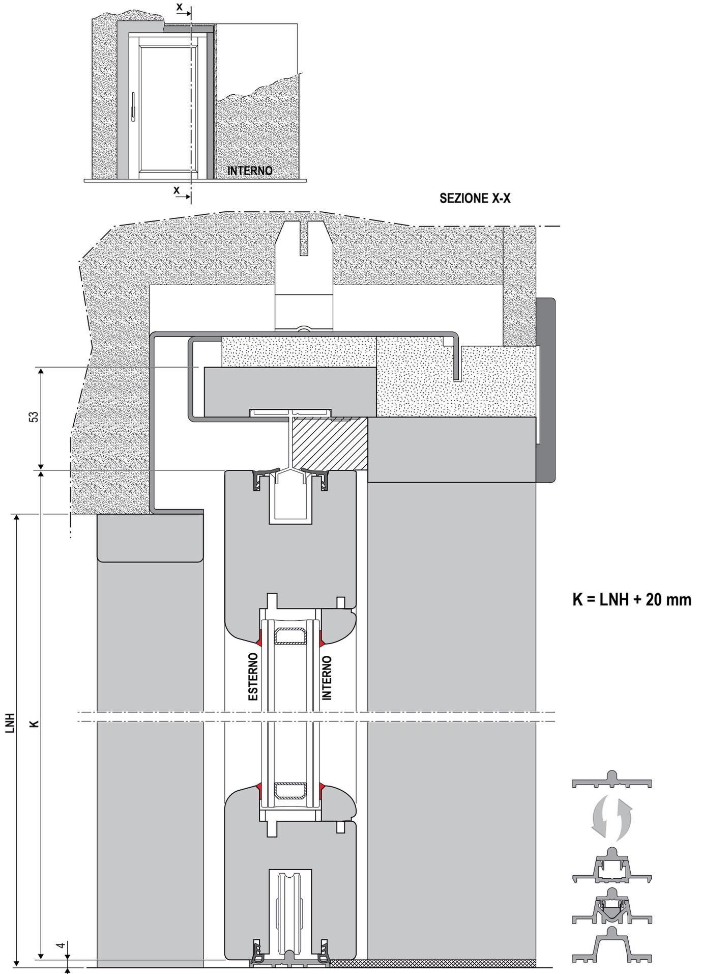
Sezione orizzontale nodo lato serratura
